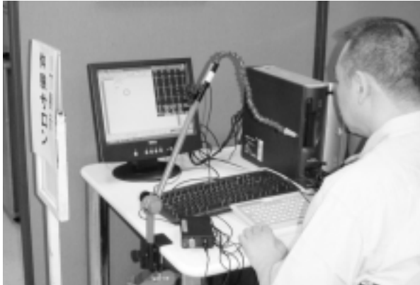
口もとにあるチューブのようなものは息や振動でパソコンを制御できるパソコンの入力機器です
