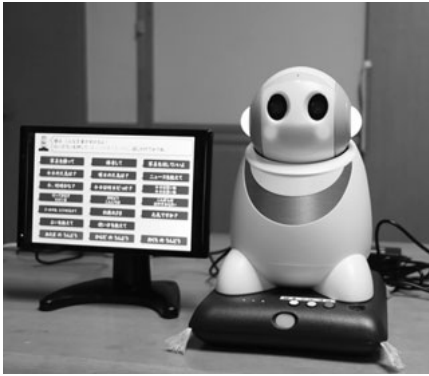
高さ30センチほどのロボットで、AIスピーカや照度センサーを内蔵している
